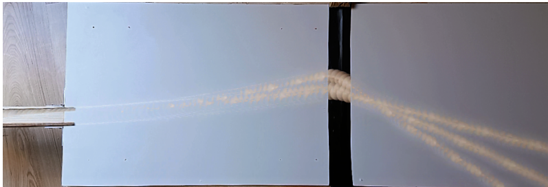
ABBILDUNG 5.7: Die Bahnen der Kugeln 8–10 der Messreihe mit Kugeldurchmesser r = 35 mm. Die Rampe befindet sich bei y = 0 cm, die Düse des Gebläses bei x = 60 cm und y = 25 cm.
