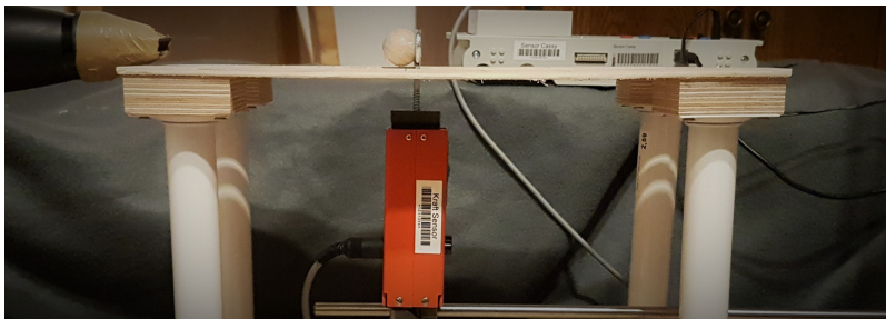
ABBILDUNG 5.2: Die orange-farbige Box in der Mitte des Fotos vom Messaufbau ist ein Coulomb-Kraftmesser. Dieser ist in x -Richtung beweglich an eine Stativstange montiert. Ein eingeschraubter Haken ermöglicht die Befestigung von zu vermessenden Luftwiderständen.
