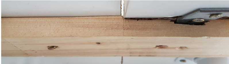
ABBILDUNG 4.16: Zu sehen ist der Übergangsbereich zwischen schiefer Ebene und waagerechter Platte, der jeweils an der Vorder- und Hinterkante mit einem passend abgehobeltem Brett fixiert wird. Der um 15° geneigte Plattenteil ist erst nach den Messungen hinzugefügt worden, um der Winkelaufspaltung der Kugeln genüge zu tun (d. h., dass die Breiten der einzelnen Detektoren nach rechts hin zunehmen müssen.)
