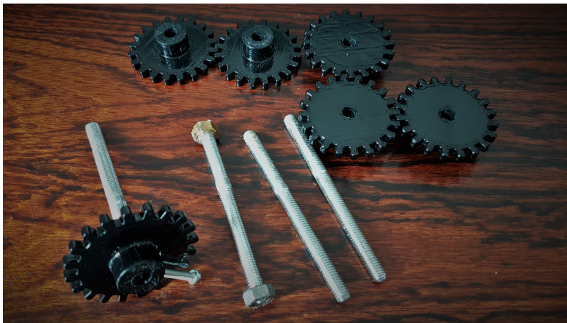
ABBILDUNG 4.12: Fotografische Abbildung der Zahnräder und Gewinde nach dem Ausbau. Bei Versuchen vor dem Einkleben der Muttern haben beide Komponenten gut funktioniert, wurden jedoch bei der Arretierung an der Beschleunigereinheit in ihrer Funktionalität zerstört (unter anderem durch Kleberückstände und mangelhafte Parallelität).
