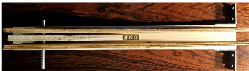
ABBILDUNG 4.13: Die Starttrampe ist auf ein Brett montiert, welches wiederum mit zwei Winkeln an den Experimentiertisch angeschraubt werden kann. Durch die Anordnung auf einem schmalen Brett lässt sich zum Einen die Rechtwinkligkeit gut überprüfen, zum Anderen erlaubt es den Zahnrädern in vertikaler Richtung bis unterhalb der Tischplatte zu reichen. Auf der linken Seite mittig ist ein Holzblock mit Ausbohrungen, durch welche die Gewindestangen zur Zentrierung gesteckt hätten werden sollen.
