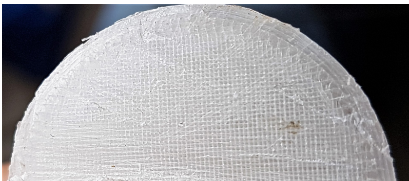
ABBILDUNG 4.15: Auf diesem Foto einer aufgeschnittenen, 3D-gedruckten Kugel ist gut zu erkennen, dass die Wandschicht der Kugel mit einer höheren Dichte gedruckt wurde.
