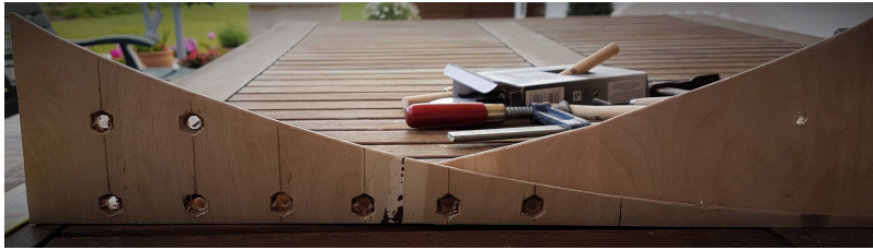
ABBILDUNG 4.11: Seitenansicht der gebauten Rampensegmente. Mittels eines nicht dehnbaren Fadens, Winkeln und einigen Schraubzwingen wird die Form angezeichnet und anschließend auf der Abfallseite ausgesägt. Die Annäherung an die endgültige Form erfolgt durch einen fein eingestellten Schweißhobel. Nach dem Durchbohren mit einem 6 mm Bohrer werden die Aussparungen für die Mutteraufnahme mit einem Stechbeitel gefertigt.
