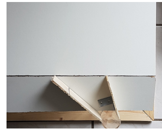
ABBILDUNG 4.18: Vorschlag einer Detektoranordnung: Je geringer der Detektionswinkel ist, desto größer muss die Breite der einzelnen Detektoren sein. Damit selbst bei den größten Detektoren alle Kugeln in die Röhren rollen können, ist der rechte Teil der Platte um 15^\circ geneigt. Ein letzter Detektor wird am rechten Ende angebracht.
